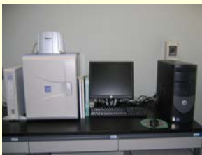
▶ 化学発光検出装置 Fuji LAS-3000mini
